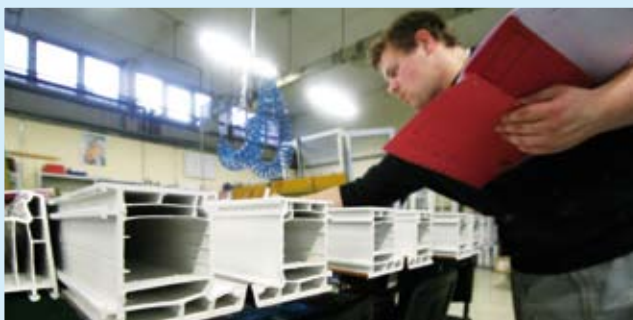
Güteprüfer kontrollieren die exakte Einhaltung der Güte- und Prüfbestimmungen.
