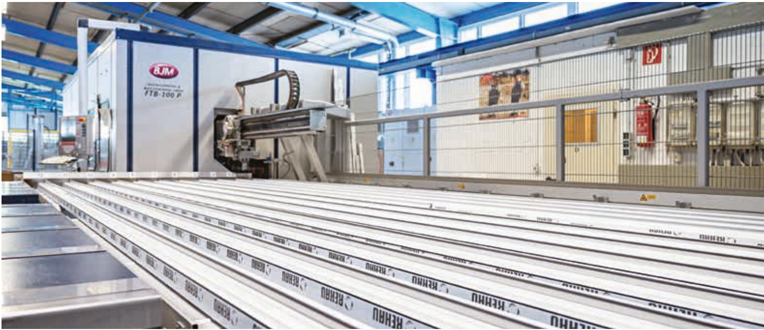
CNC-Zuschnitt- und Bearbeitungszentrum (Kunststoff-Fertigung)
